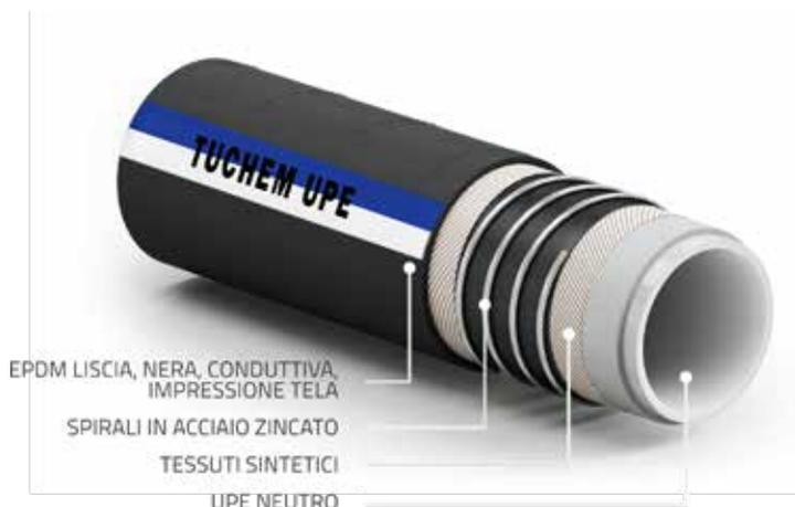
Tubo progettato secondo la norma EN 12115 per aspirazione e mandata di prodotti chimici. Tubo testato in accordo con le principali normative per i materiali in contatto con gli alimenti (MOCA). Prodotto in conformità alla GMP (CE 2023/2006).
